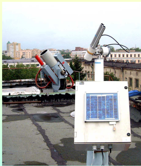
Панорамная многоволновая станция в комплексе с солнечным радиометром Cimel
