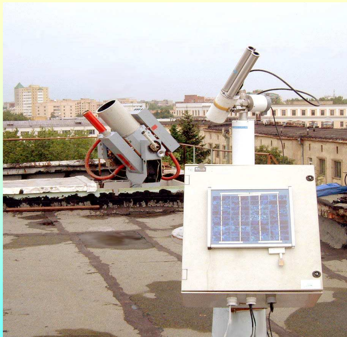
Лидар панорамного обзора и сканирующий солнечный спектральный фотометр CIMEP
