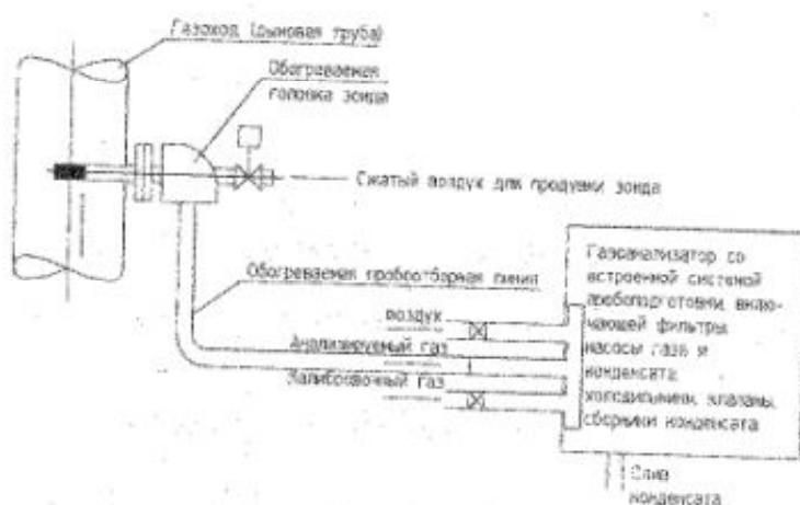
Рисунок В.1 – Схема упрощенной пробоподготовки газоанализатора
